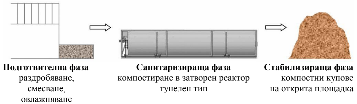
Фиг.10. Технологична схема на площадка за закрито тунелно компостиране
